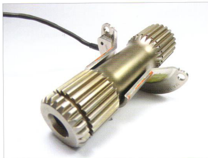
Drehmomentsensoren sorgen für eine kontinuierliche Überwachung der Schneckenwellen im Extruder
